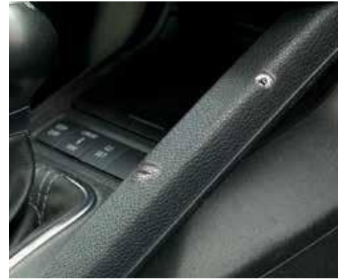
Bohrlöcher im Verkleidungsteil
