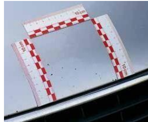
Mehr als fünf Steinschläge pro 10 \times 10 cm
