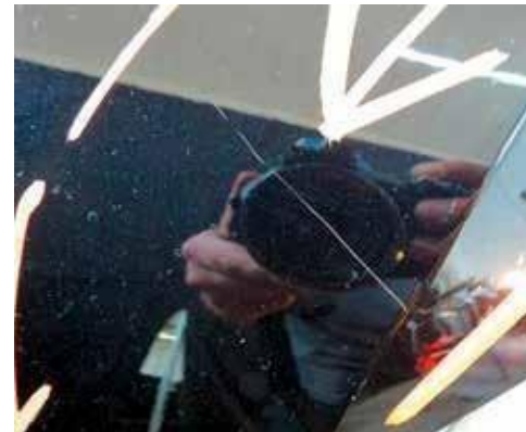
Beschädigung des Basislacks
