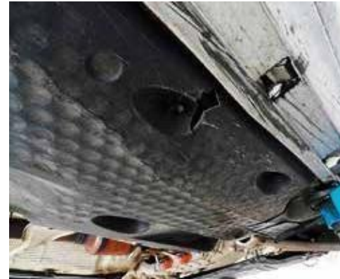
Beschädigung der Unterbodenverkleidung
