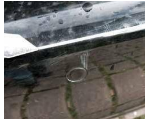
Lackschäden am Stoßfänger
