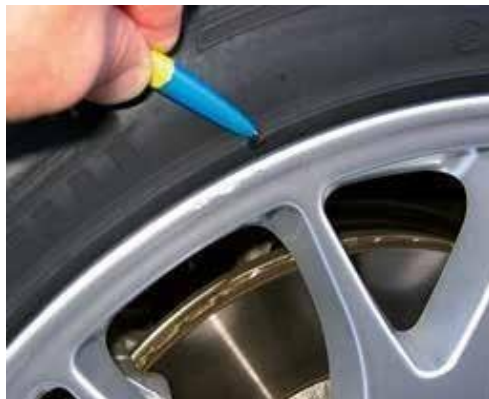
Leichte Materialabtragung an der Scheuerleiste
