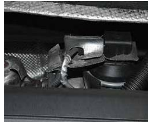
Beschädigung durch Nagetiere
